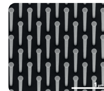
Epitaxie d'un réseau de nanofils de GaP sur SiO 2
