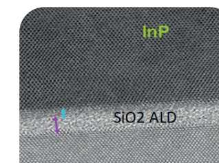
Couche d'interface en SiO 2 déposée par ALD (Atomic Layer Deposition)
